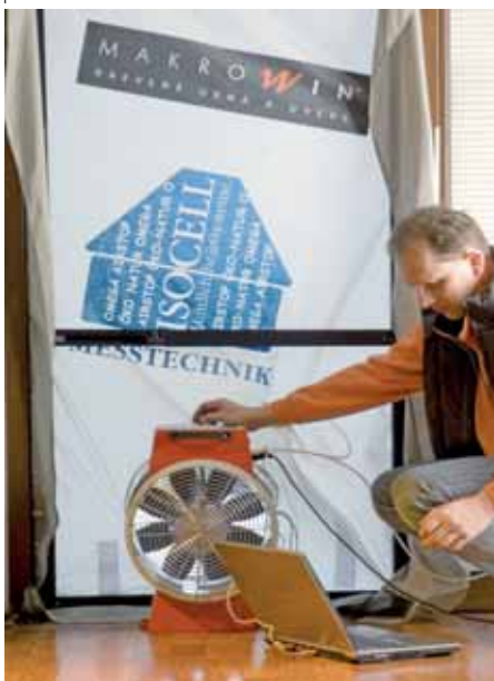
Blowtest 3000 – prenosné zariadenie na meranie vzduchotesnosti pasívneho domu.
