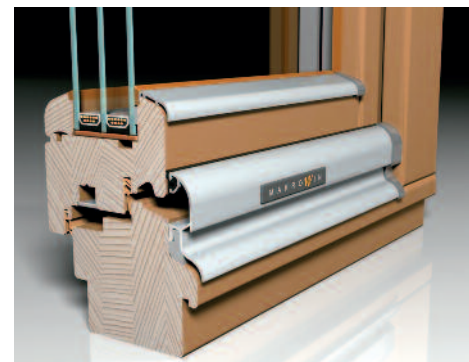
Drevené okno MAKROWIN 88 – stavebná hĺbka 88 mm. Okno sa štandardne osádza s izolačným trojsklom a je vhodné pre nízkoenergetické domy.
